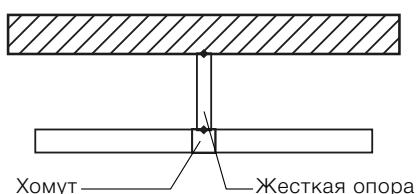
Рисунок 11. Неподвижная опора, выполненная с использованием хомута
