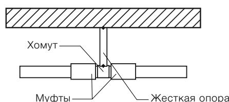
Рисунок 13. Неподвижная опора, выполненная хомутом между муфт
