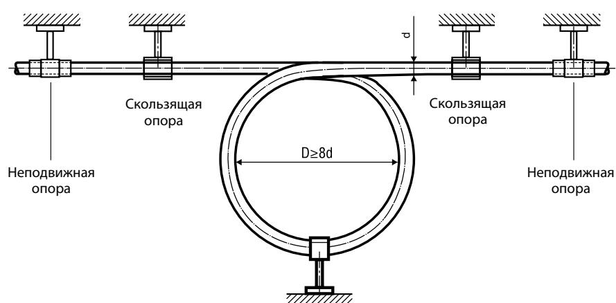
Рисунок 4. Петлеобразный компенсатор
