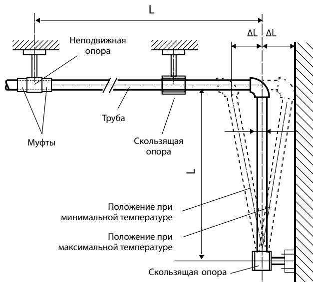
Рисунок 2. Г-образный элемент напорного полипропиленового трубопровода
