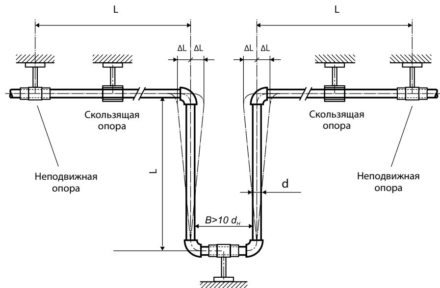
Рисунок 3. Π-образный компенсатор
