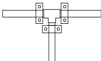
Рисунок 9. Неподвижная опора в месте ответвления
