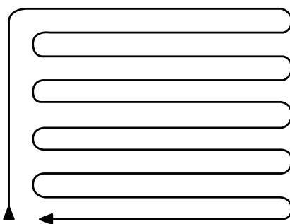
Рисунок 25. Варианты укладки теплого пола змейкой
