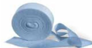
**Гидроизоляционная лента КНАУФ-Флехендихт** служит для гидроизоляции сопряжения стен и пола, внутренних углов при устройстве санкабин. Лента приклеивается в углы после нанесения гидроизоляции КНАУФ-Флехендихт.
