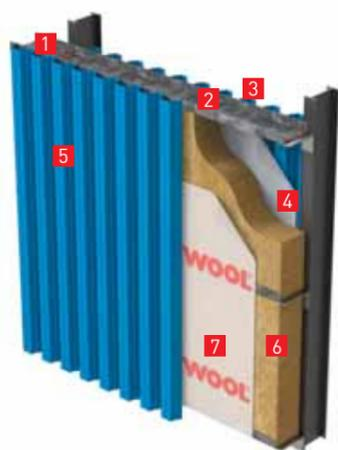
1. Саморезы, заклепки, болты – крепления облицовочного материала и профилей между собой;
