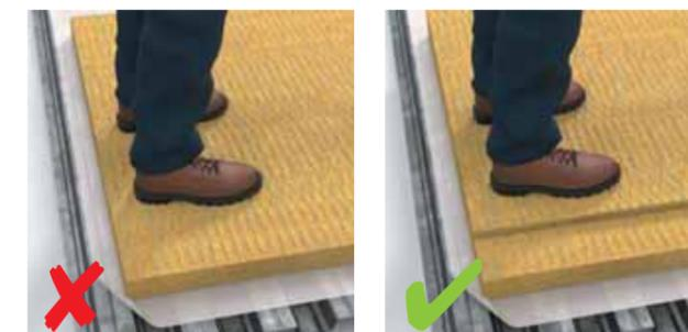
При использовании плит РУФ БАТТС В и РУФ БАТТС Н не допускается механическое воздействие на РУФ БАТТС Н.
