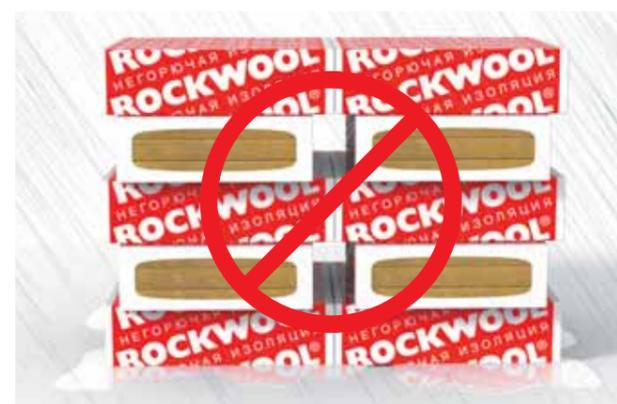
Хранение изоляционных материалов ROCKWOOL. Изоляционные плиты и маты ROCKWOOL должны храниться в закрытых, сухих складских помещениях.
