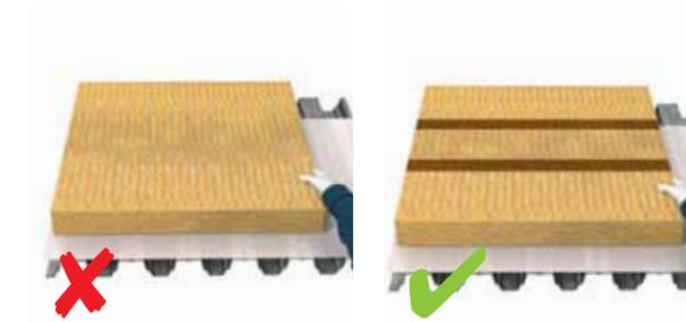
Плиты РУФ БАТТС ОПТИМА и РУФ БАТТС ЭКСТРА укладываем на основание маркированной стороной вверх.
