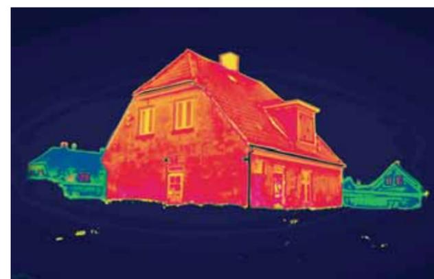
Теплопотери можно увидеть в ходе тепловизионного обследования зданий на снимках тепловизором. В результате на термограмме мы получаем картинку, по которой можно оценить интенсивность потерь тепла. Наиболее яркие места – зоны с высокой температурой. Это те места, где теплопотери происходят наиболее интенсивно.
