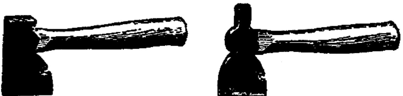
Рис.13. Топор-молоток для полов и топор с головкой для гонта и забивки кровельных гвоздей
