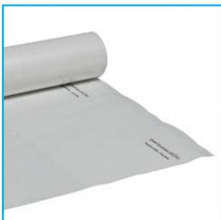
Паронепроницаемый барьер LDS 100 изготовлен из специальной полипропиленовой пленки, устойчивой к старению. Коэффициент  $S_d \geq 100$  м.
