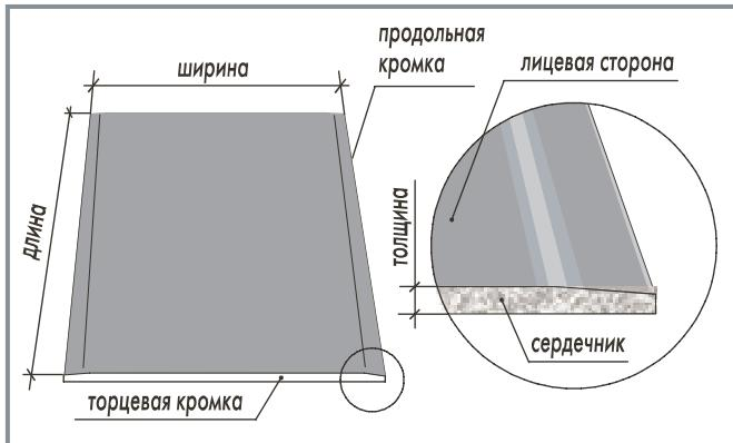
КНАУФ-листы - это производимые фирмой КНАУФ гипсокартонные листы (ГКЛ), строительно-отделочный материал, применяемый для облицовки стен, устройства перегородок, подвесных потолков, огнезащитных покрытий конструкций, а также для изготовления декоративных и звукопоглощающих изделий.
