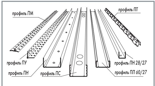
Металлические профили КНАУФ являются одной из главных составляющих комплектных систем КНАУФ и служат для формирования каркасов, различных по конструкции и назначению, в том числе для сборных перегородок, облицовок и подвесных потолков. Каркасы в свою очередь являются жестким основанием для крепления гипсокартонных (гипсоволокнистых) листов и продукции на их основе.
